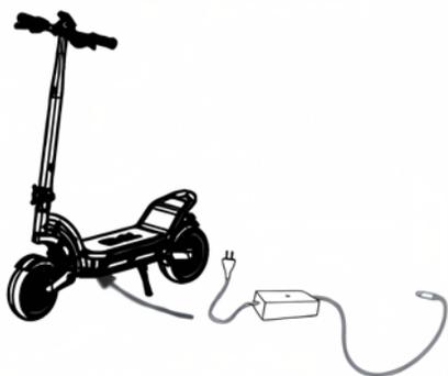
**Atenção: Nunca utilize outro tipo de carregador além daquele que acompanha o veículo. O uso de carregadores não originais podem danificar a bateria e comprometer a segurança do veículo.**
