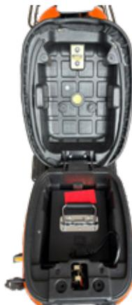
3 – Desconecte a bateria removendo o conector
