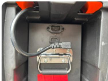
4. Cuidadosamente remova a bateria do seu compartimento e leve próximo a uma tomada.
