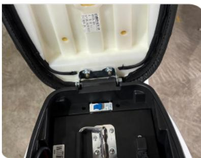
3 - Desconecte a bateria removendo o conector.
