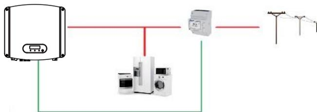
Medidor inteligente como acima do método de conexão **SDM230-Modbus** e configuração do método de taxa de baud para Modbus, consulte seu manual de usuário.
